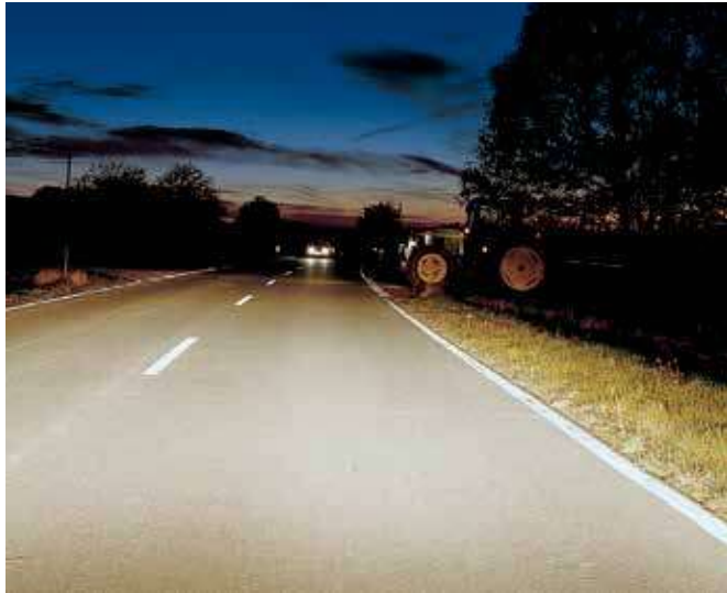
Distribución típica de la luz y color de temperatura de una luz de cruce en un foco halógeno convencional.
