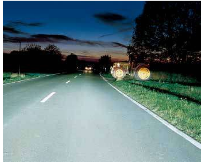
Distribución típica de la luz y color de temperatura de una luz de cruce en un foco HID.
